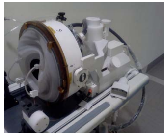
1.5T 専用頭部コイル (患者テーブルクレードルに取り付け)
